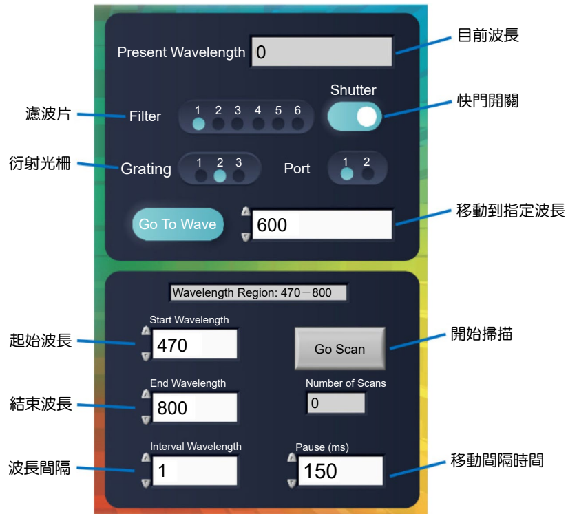
圖 6. LabVIEW 單光儀使用者控制介面設計。
