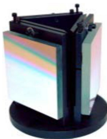
圖 4. 可安裝 Newport 三種規格的衍射光柵旋轉台 (5) 。
