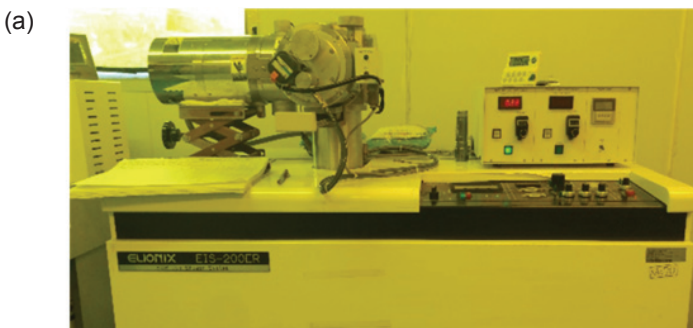
圖 9. (a) Elionix EIS-200ER 電子迴旋共振式離子束蝕刻機。(b) Elionix EIS-220W 電子迴旋共振式離子濺鍍機。
