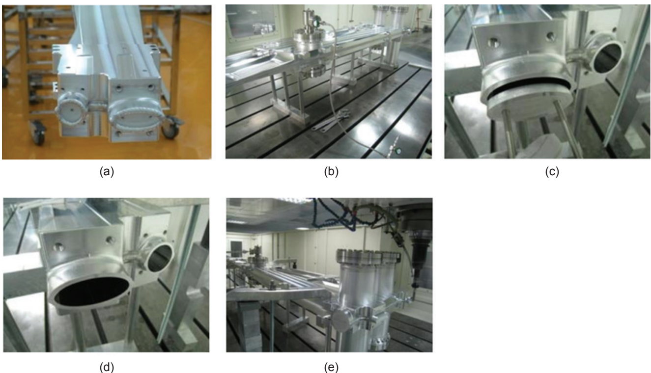
圖 6. 轉彎段真空腔銲接完成後送回酒精加工無塵室 CNC 機台進行二次加工：(a) 加工前、(b) 充填乾燥氮氣、(c) 切除封板、(d) 加工週邊部位垂直端面；以及 (e) 測量真空腔平面度。
