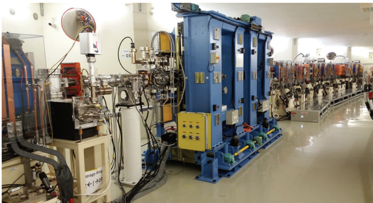
圖 12. TPS 隧道區內之儲存環 1/24 段，包括長直段 (已安裝一組插件磁鐵) 及 14 m 彎段真空系統。
