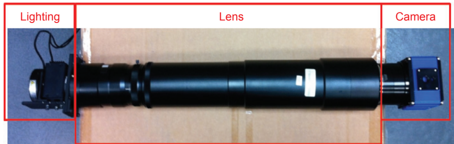
圖 4. 製作完成之晶片正面光學取像裝置實體圖。
