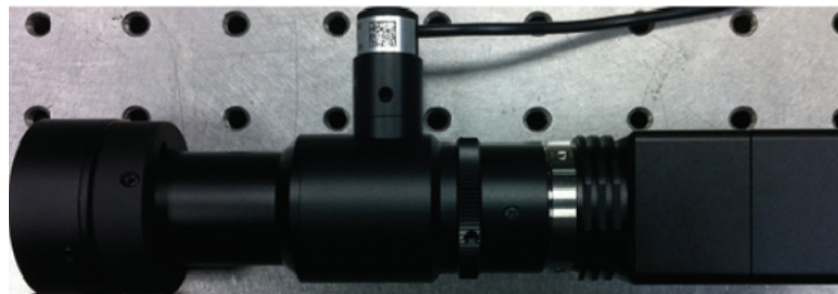
圖 6. 製作完成之晶片側面光學取像裝置實體圖。
