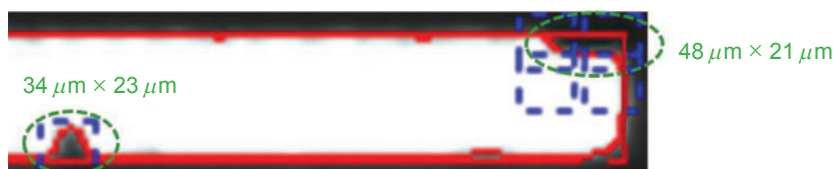
圖 16. 晶片側面影像及其檢測結果瑕疵尺寸。
