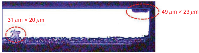
圖 17. 晶片側面之光學顯微鏡影像及瑕疵尺寸
