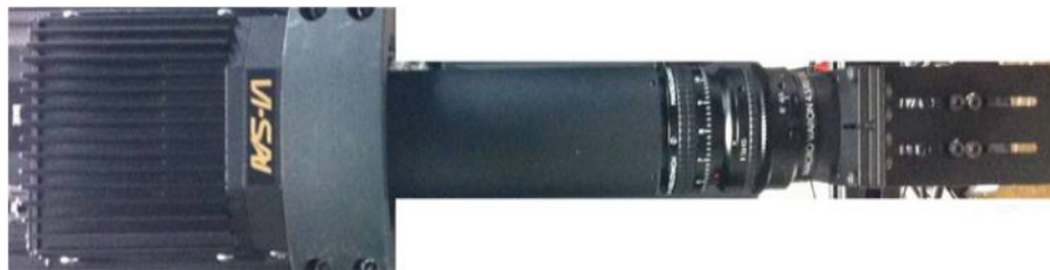
圖 5. 製作完成之晶片背面光學取像裝置實體圖。
