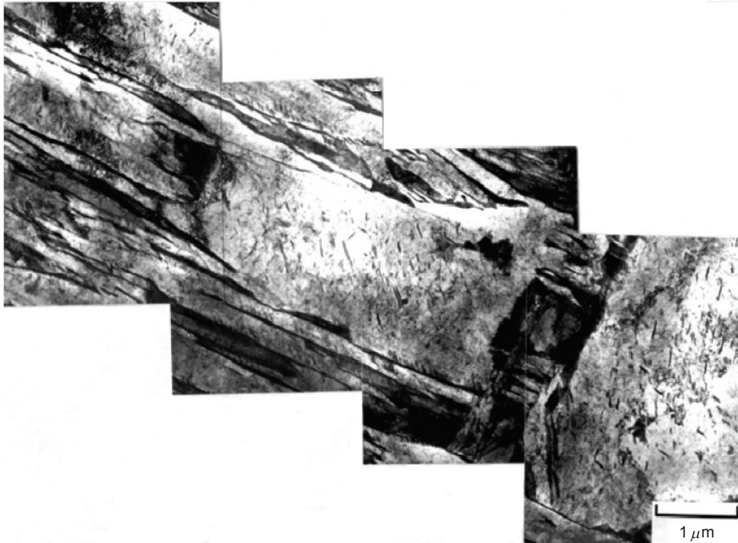
圖 3. 圖 1 NAK 80 析出硬化型模具鋼自動回火麻田散鐵組織之 TEM 影像。
