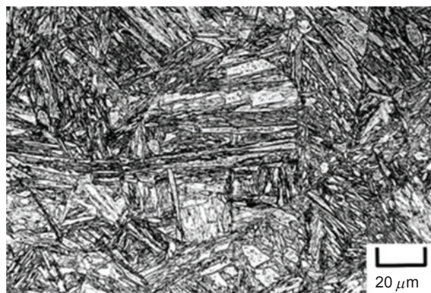
圖 1. 析出硬化型模具鋼 NAK 80 之自動回火麻田散鐵組織。
