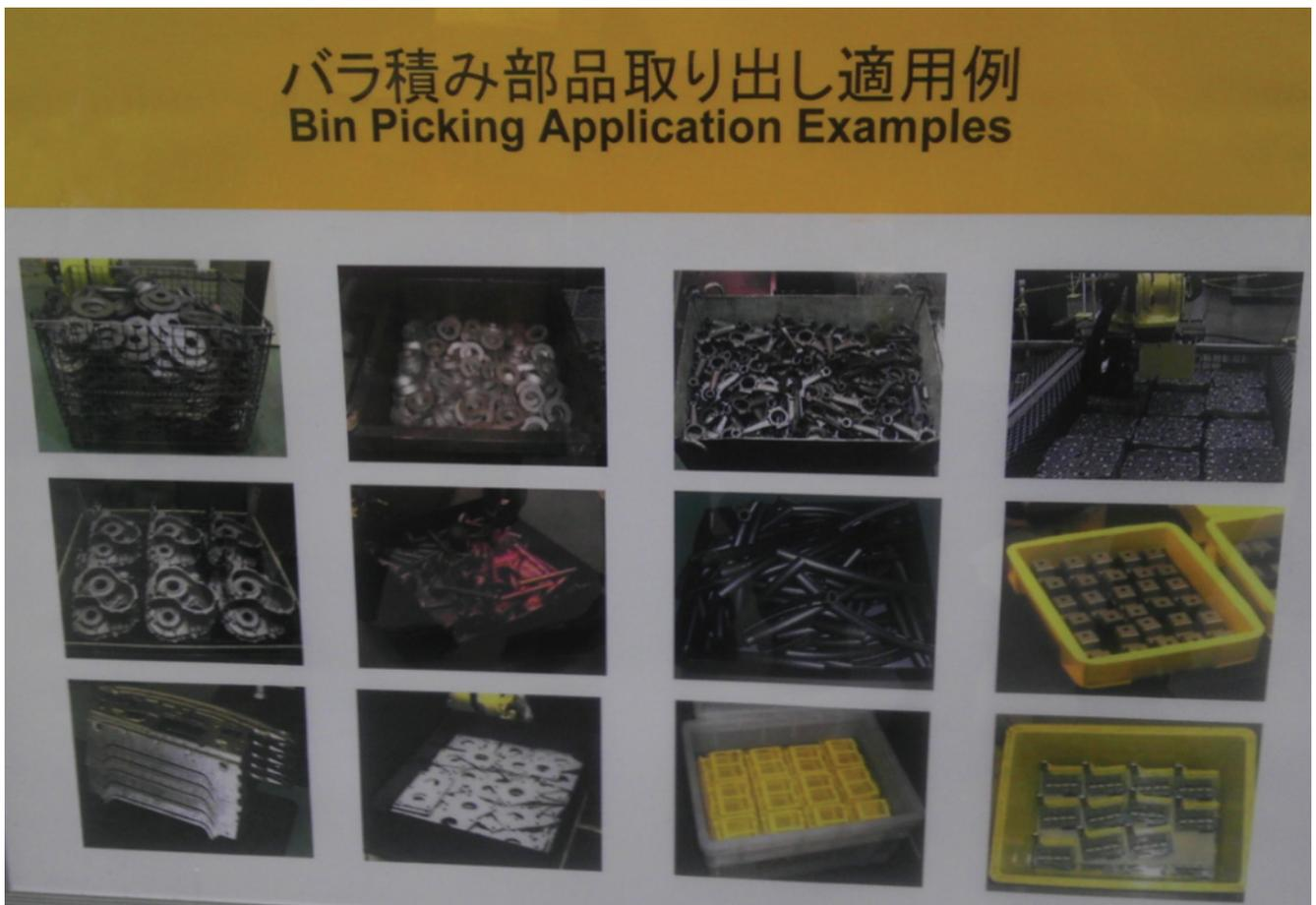
圖 3. Fanuc RBP 可適用之工件。
