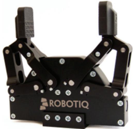
圖 5. RobotiQ 夾爪。
