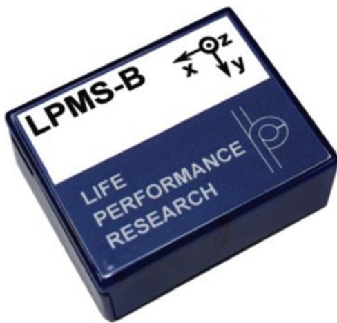
圖 4. LPMS-B 六軸加速度感測器。
