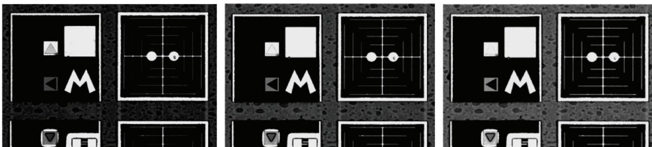
圖 9. 相機曝光時間分別為 100、150 及 200 ms (由左至右) 所取得的晶粒影像。
