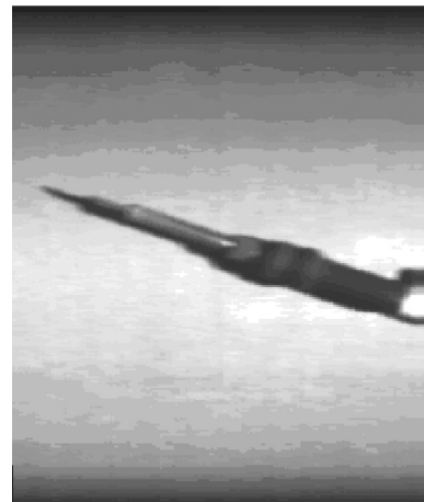
圖 12. 烙鐵於室溫下，使用短波紅外取像模組拍攝。
