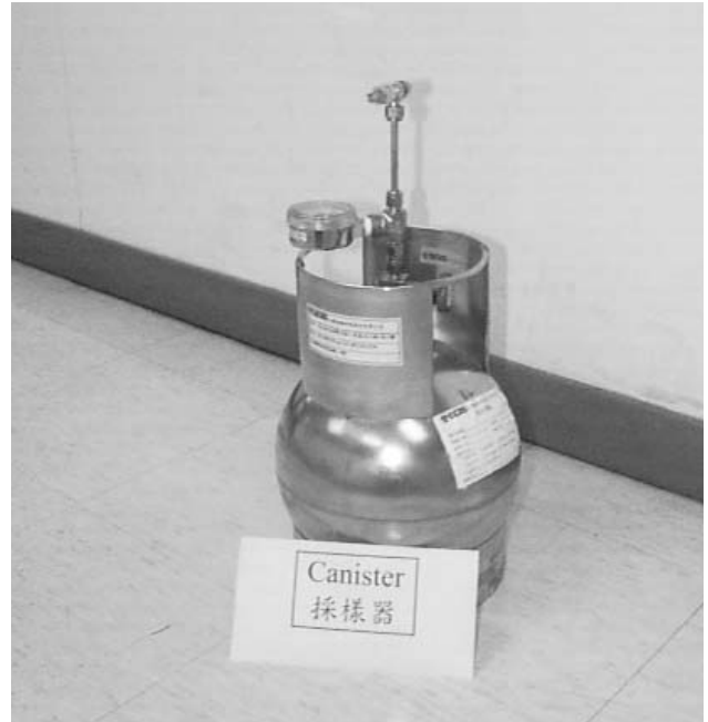
圖 3. 不鏽鋼採樣筒採 (加裝節流閥與真空表)。
